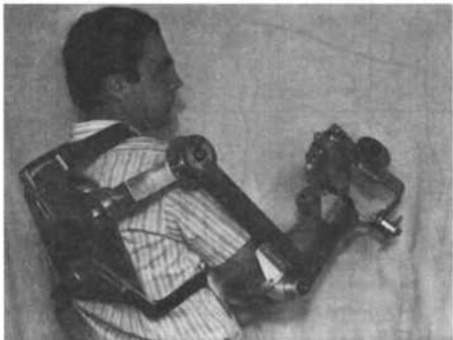
Рис. 4.5. Общий вид экспериментального стенда для измерения ограничений в суставах руки человека
