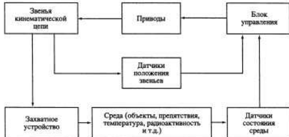
Рис. 1.3. Упрощенная блок-схема промышленного робота
