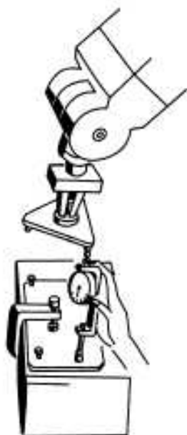
Рис. 7.16. Рабочий момент измерения l -координаты на стенде "Аттестат"
