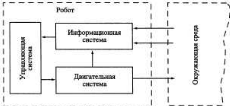
Рис. 2.1. Обобщенная структурная схема робота
