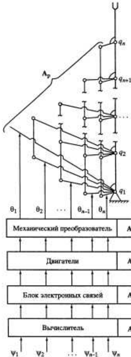
Рис. 5.4. Общая схема преобразования информации о программных перемещениях звеньев робота
